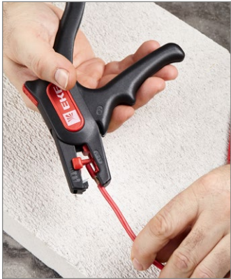
Стриппер для снятия изоляции с провода на нужную длину.
