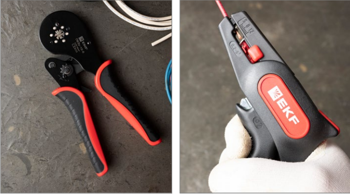
Обжимные клещи (кримпер) с матрицей именно для НШВИ. Стриппер для снятия изоляции с провода на нужную длину.
